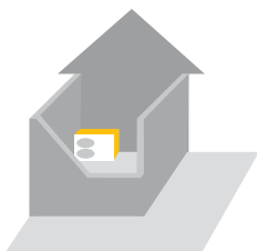
PAC placée dans une cour intérieure : + 9 dB(A)
