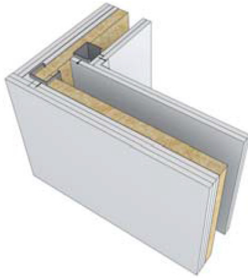
Figure 3.3.7 : Angle d'une cloison séparative
