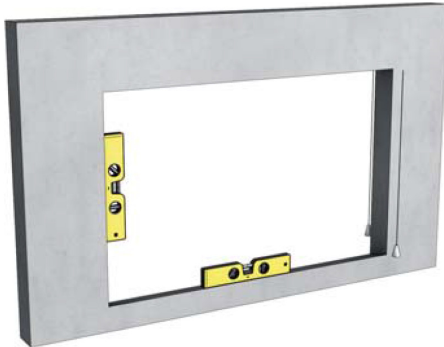
Figure 3.4.5 : Inspection de l'ouverture avant la mise en œuvre des dormants
