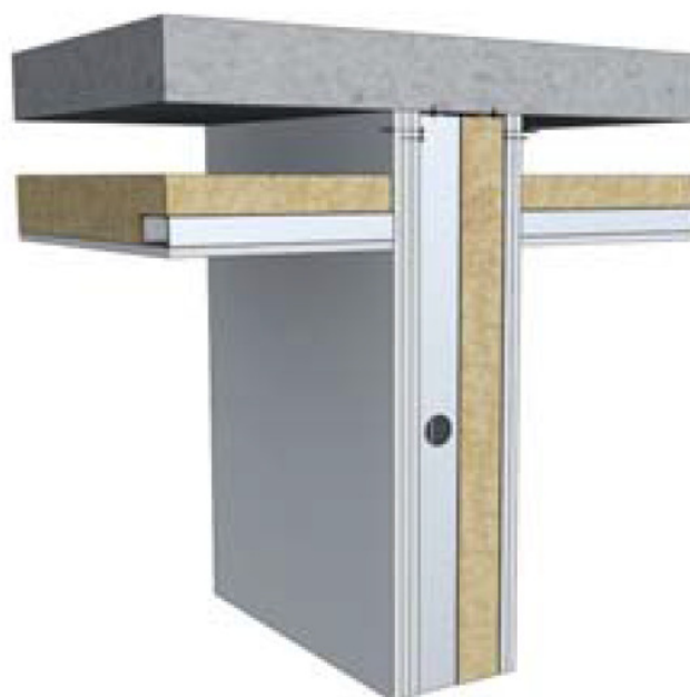
Figure 3.3.4 : Jonction entre plafond suspendu et cloison séparative légère – Pour un isolement visé important (entre appartements par exemple)
