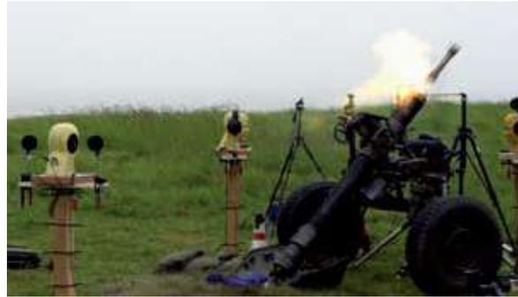
Fig. 1 : Photographie d'un tir de mortier avec des têtes artificielles acoustiques pour la mesure de l'efficacité de protecteurs auditifs (photo ISL)
