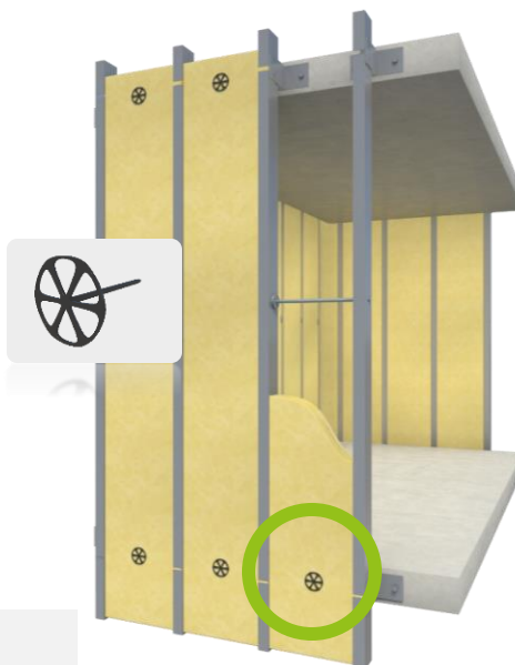
Pose de l'isolant Isofaçade 30 ou 32
