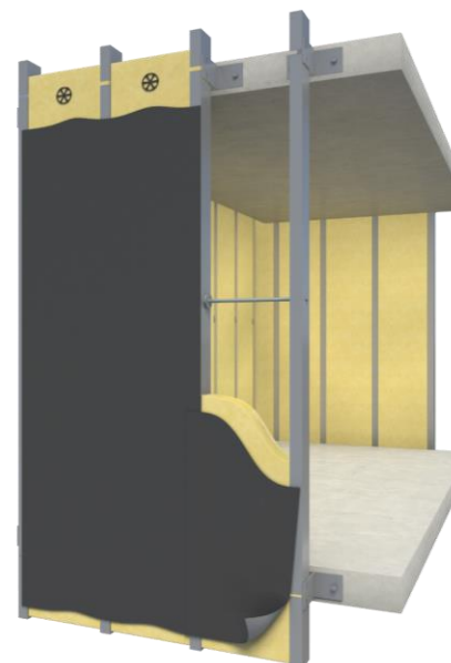
Pose de la membrane ISOVER UV-Façade
