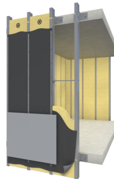
Pose du bardage
