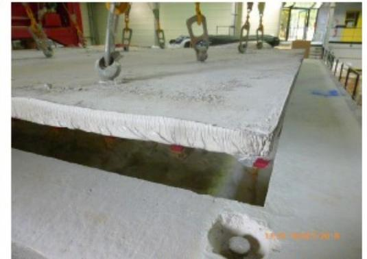
Pose de la préchape en béton armé (Essais 14 à 17)
