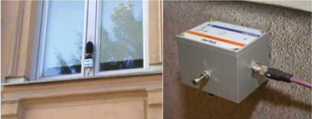
illustration III : Points de mesure (à gauche : sonomètre – à droite : géophone triaxial)
