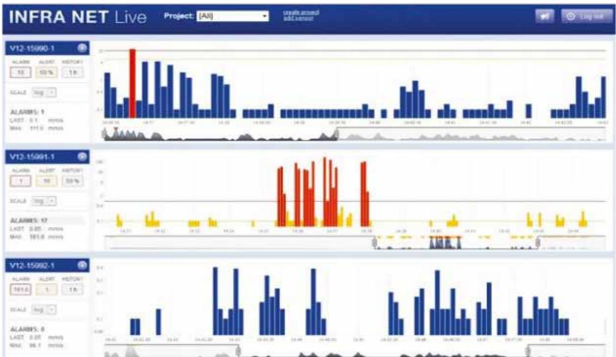
Illustration IV: Vue de l'interface Live avec évolution des niveaux et comparaison aux seuils
