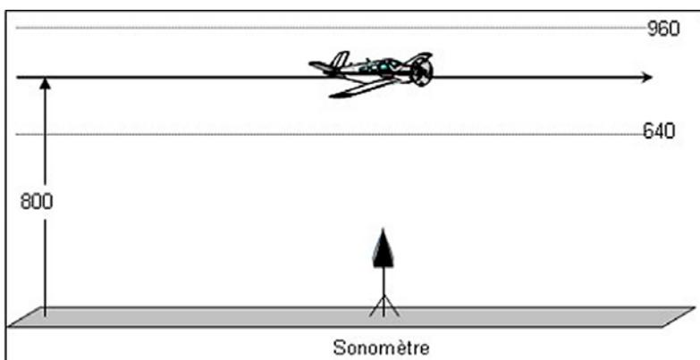
La hauteur d'essai fixée à 800 ft a pour but d'obtenir une émergence suffisante du bruit de l'avion par rapport au bruit de fond, en particulier pour les survols opérés à faible vitesse. Les niveaux de bruit sont ensuite corrigés pour refléter le bruit que produit l'avion à une hauteur de 1000 ft (hauteur courante du circuit de piste qui constitue la principale source de gêne ressentie par les riverains)
