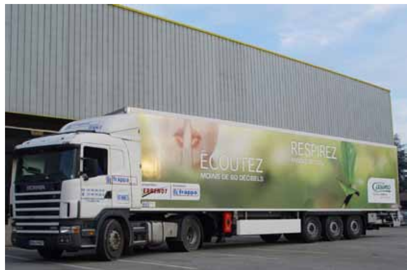
Semi Casino — la remorque FT silent Green avec moteur insonorisé fonctionnant à l'azote liquide. 1 er véhicule Piek certifié en France par la Cemafroid (- de 60 décibels)
