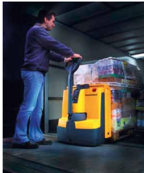
restreint. Ainsi, le chariot est un outil particulièrement économique pour les opérations de chargement et déchargement de camions mais aussi pour le transport de palettes sur courte distance. L'EJE 116 peut soulever et transporter des charges allant jusqu'à 1600 kg.
