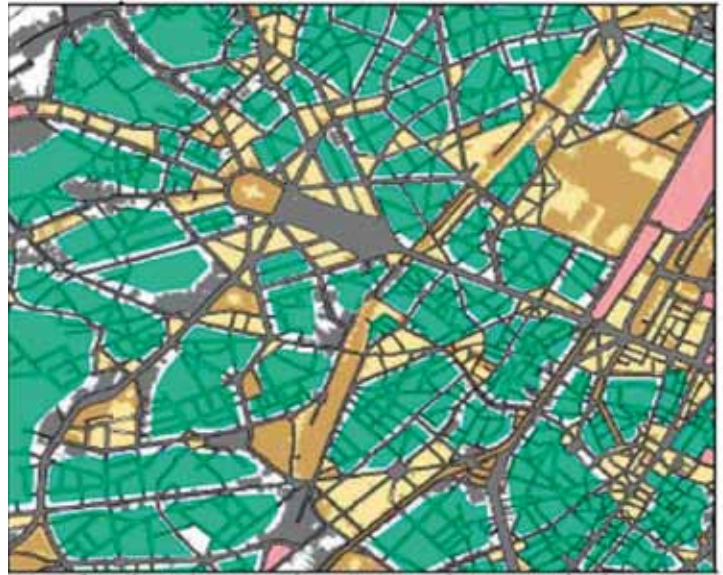
Rose : îlots éliminés car voués uniquement à des activités économiques Gris : bruit des transports terrestres (> 55 dB L den ) Jaune : îlots éliminés car soumis à niveau de bruit supérieur à 55 dB L den Bleu : îlots potentiellement calmes selon le premier filtre acoustique
