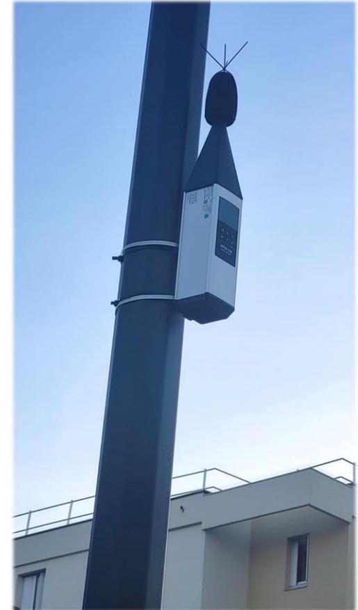
Sonomètre C50 installé sur site
