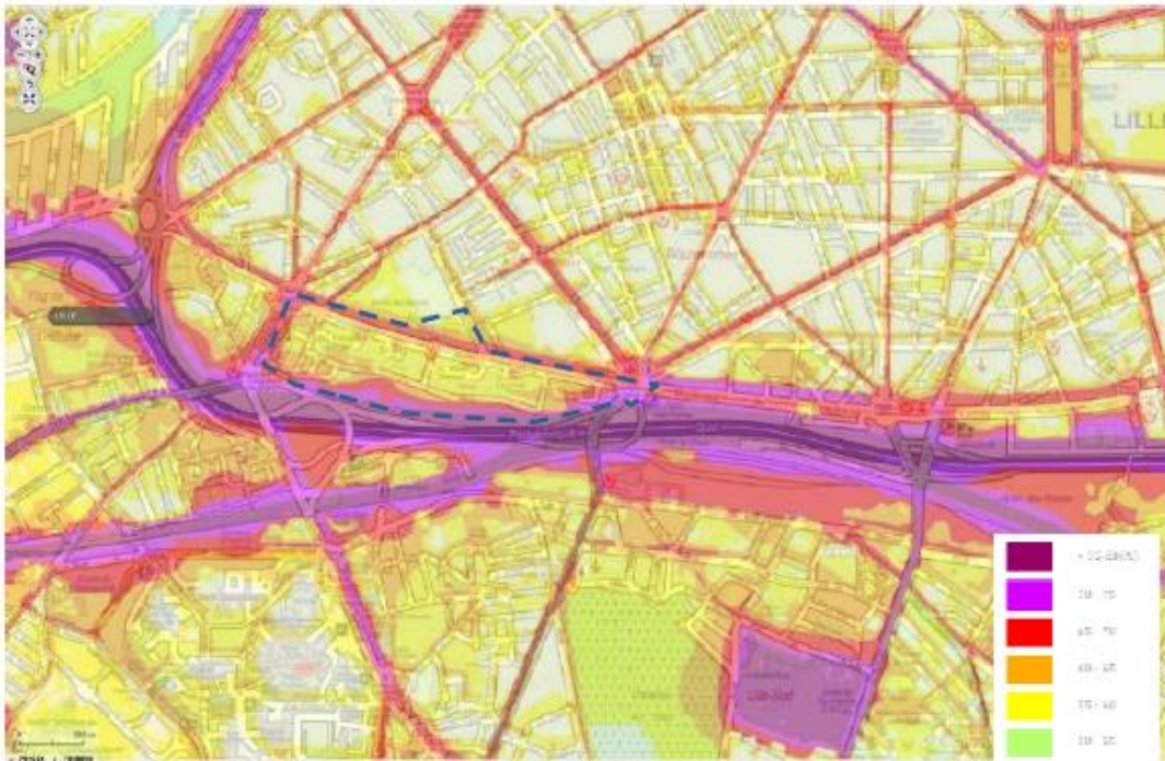
Figure 129 : carte de type A – niveau d'exposition au bruit Lden (24h) en multi exposition
