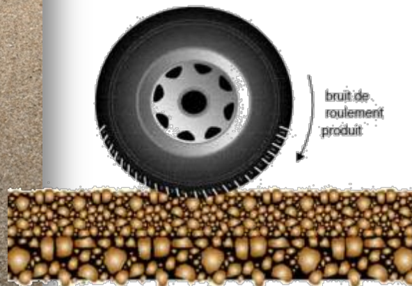
Texture positive + revêtement dense maximalisent le bruit
