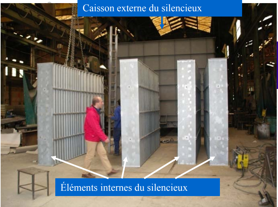
Montage des gaines et de la cheminée
