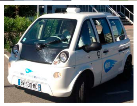
Station de mesure embarquée air/bruit sur véhicule électrique MIA.
