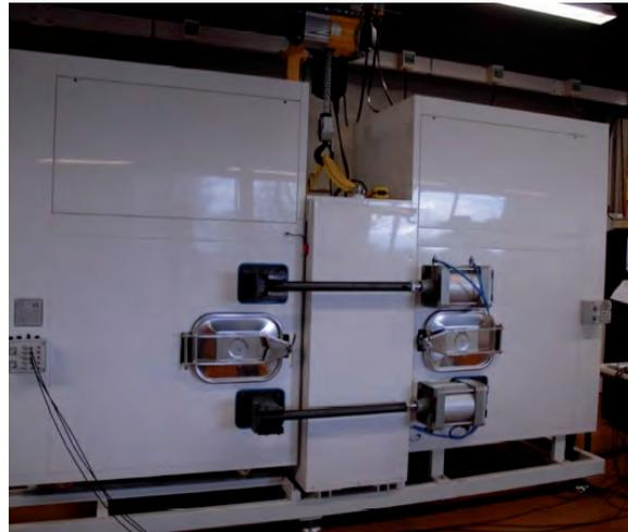
Fig. 5 : Dispositif de mesure de transferts hygrothermiques
