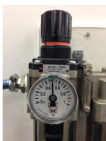
Fig. 12: Nanomètre contrôle la pression (5 bar)
