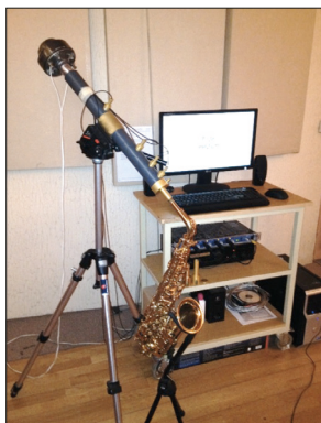
Fig. 1 : Pont d'impédance utilisé pour les mesures d'impédance d'entrée de saxophones et clarinettes
