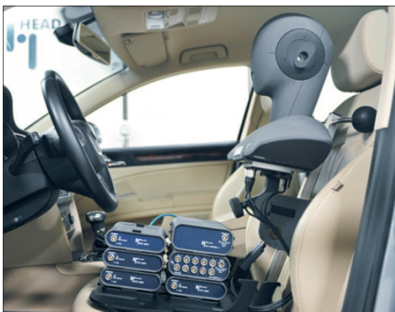
Fig. 2 : Tête artificielle numérique HMS IV en véhicule, couplée à un système d'acquisition modulaire multivoies HEADlab
