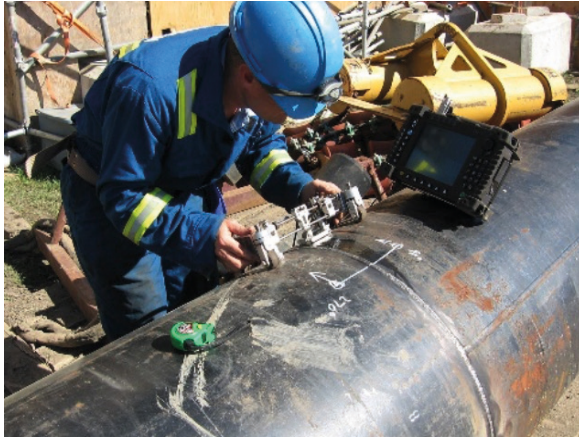
Fig. 1 : Inspection d'oléoduc par ultrasons Pipeline ultrasound testing
