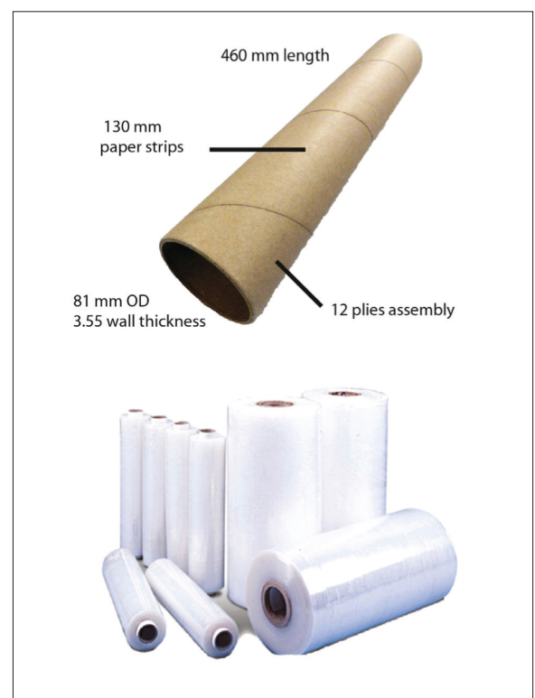
Fig. 1. Description de la géométrie du cylindre en fibre utilisée dans cette étude (en haut). Présentation du produit final emballé sous cellophane (en bas).
