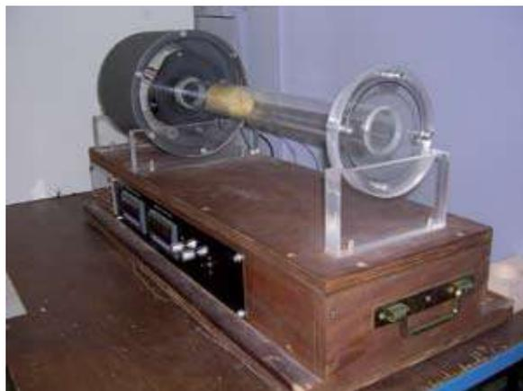
Fig. 7 : Réfrigérateur thermoacoustique de démonstration (LAUM)
